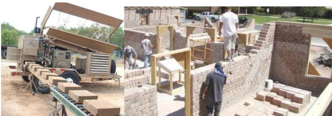
Figura 8 - Fabricação mecanizada do BTC. Fonte: (DUARTE, 2013)
