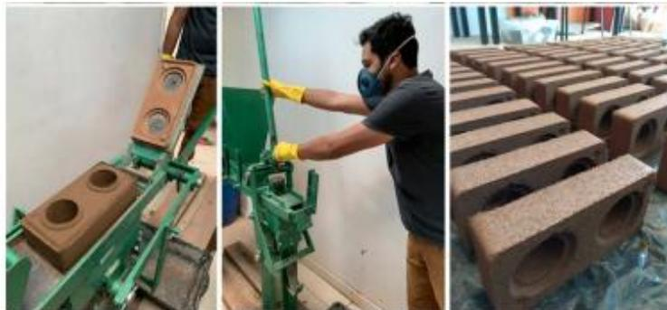
Figura 7 - Fabricação do BTC manualmente. Fonte: (SALGADO, SILVOSO e GRABOIS, 2020)
