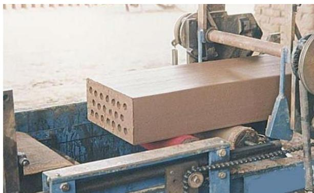
Figura 9 - Extrusão do bloco de terra crua. Fonte: (DUARTE, 2013)
